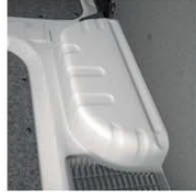
Flate hjulbrønner gjør det enklere å stable last.
