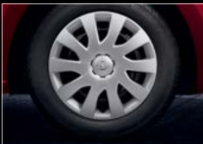
16" stålfelg med 10-eiket hjulkapsel, 6 J x 16" (QP9), 215/65 R 16-dekk. (Standard for EDITION varebil)
