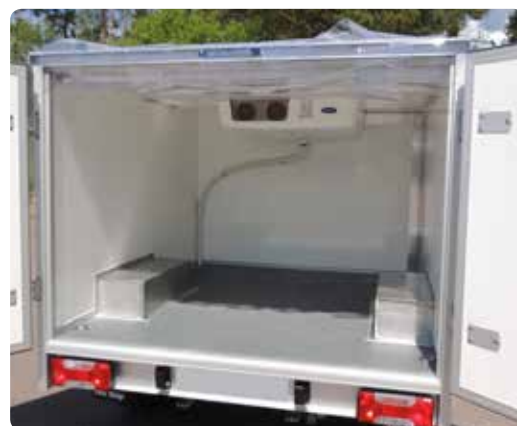
Målet mellom de isolerte hjulkassene er 1140 mm.
