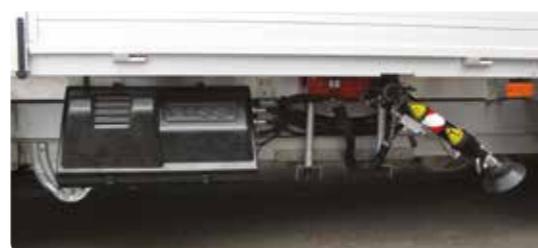
Smart plassering av hydraulikkaggregat, lett tilgjengelig for service.
