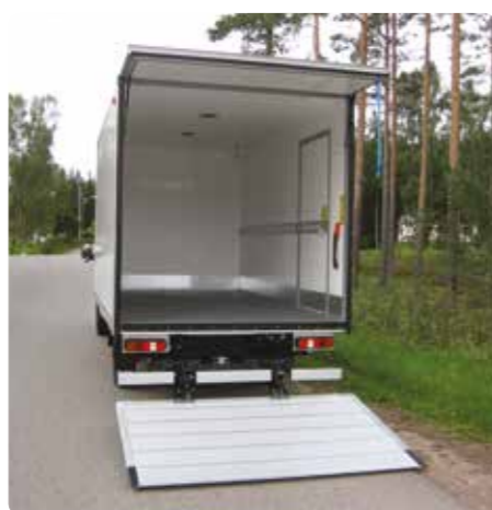
Fri innlastingshøyde med åpen liftluke.
