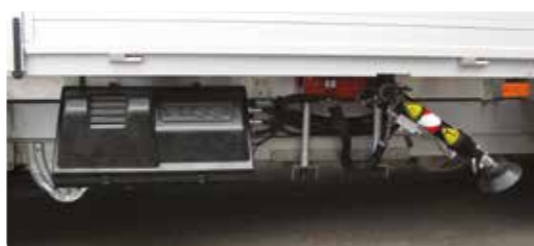
Smart plassering av hydraulikkaggregat, lett tilgjengelig for service.
