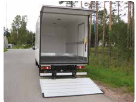
Fri innlastingshøyde med åpen liftluke.
